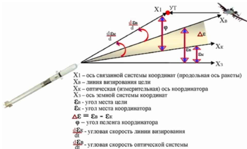
Рис. 28. К работе следящей системы координатора цели
