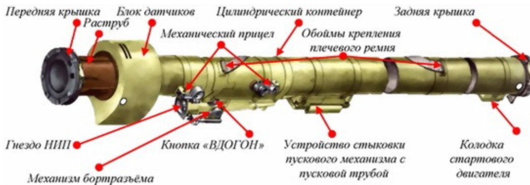
Рис. 52. Устройство пусковой трубы
