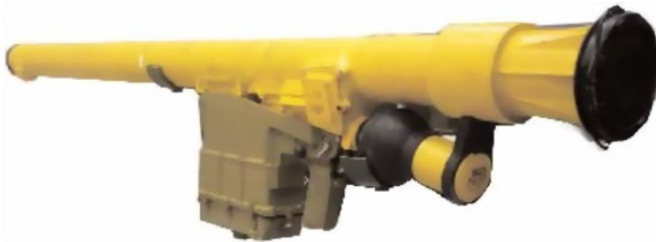
Рис. 77. Труба учебная с подстыкованным механизмом учебным
