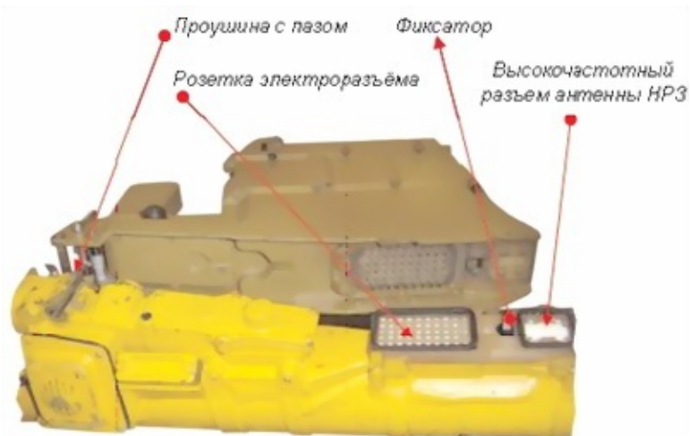
Рис. 60. Устройство стыковки пускового механизма с пусковой трубой
