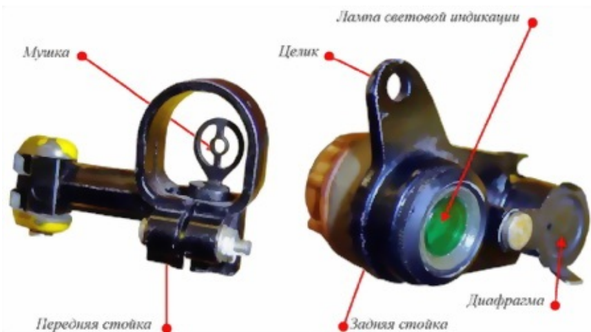
Рис. 56. Механический прицел
